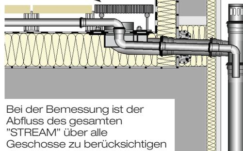
Bei der Bemessung ist der Abfluss des gesamten "STREAM" über alle Geschosse zu berücksichtigen
